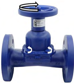
III. 23: Amener le robinet à membrane en position presque fermée. Dévisser les vis à tête hexagonale.
