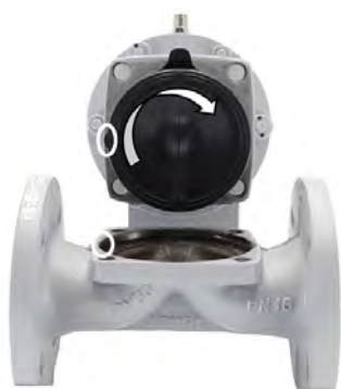
III. 20: Visser la membrane. La came de centrage de la membrane s'insère dans la poche du corps de robinet.
