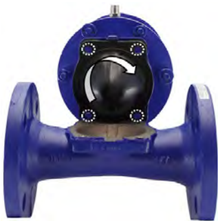
III. 31: Visser la membrane. Les cercles de perçage de la membrane et du chapeau doivent concorder.
