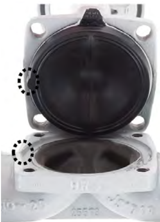
III. 15: La came de centrage de la membrane s'insère dans la poche du corps de robinet.
